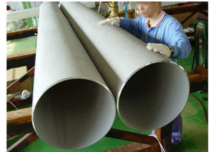
400A シームレスクリーンパイプ AP Grade 400A Seamless Clean Pipe AP Grade
