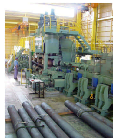
大径管用伸直機 (450A) Straightener up to 450A
