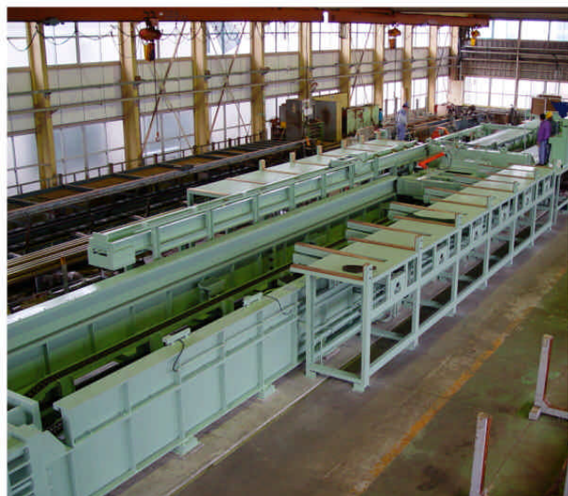
大径管用冷間引抜機 (400A) Cold Draw-Bench up to 400A
